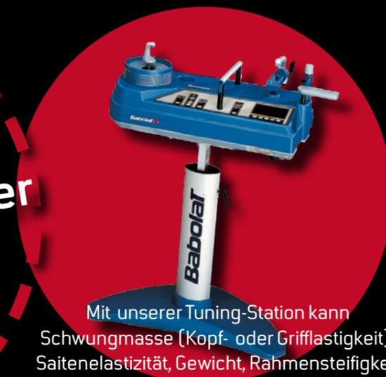
Mit unserer Tuning-Station kann Schwungmasse (Kopf- oder Griffelastigkeit), Saitenelastizität, Gewicht, Rahmensteifigkeit (Abnutzung), sowie der Balance Punkt exakt eruiert werden.
